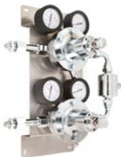
Diseñado para el suministro de gas de manera continuada mediante red de canalización a cada uno de los puestos de trabajo. Doble rampa de suministro con **intercambiador electrónico** que actúa al detectar falta de presión.
