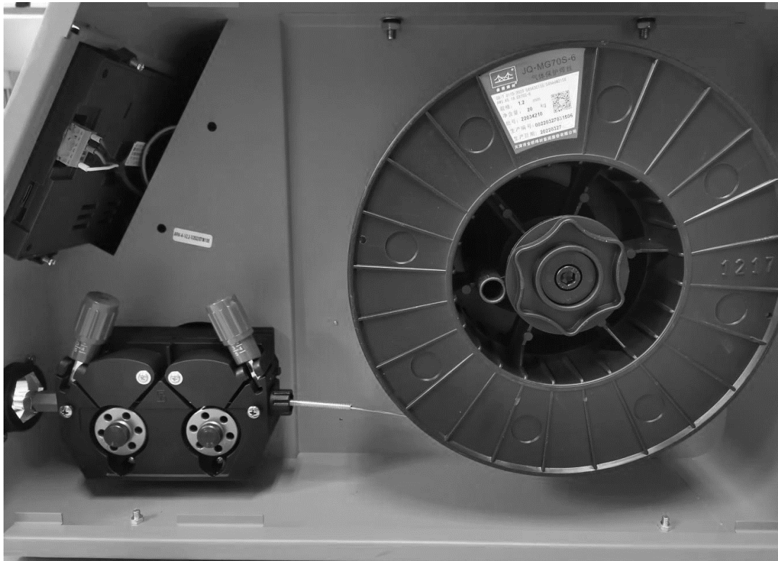
Figure 4-3 Intérieur du dévidoir de fil
