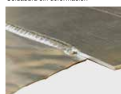
Soldadura sin deformación
