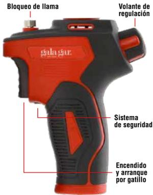
Soplete para cartucho desechable y de encendido piezoeléctrico con 3 lanzas incluidas intercambiables para soldaduras blandas y calentamiento.
